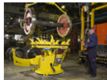
Hjulparet lyfts med travers ur bocken efter montering.
